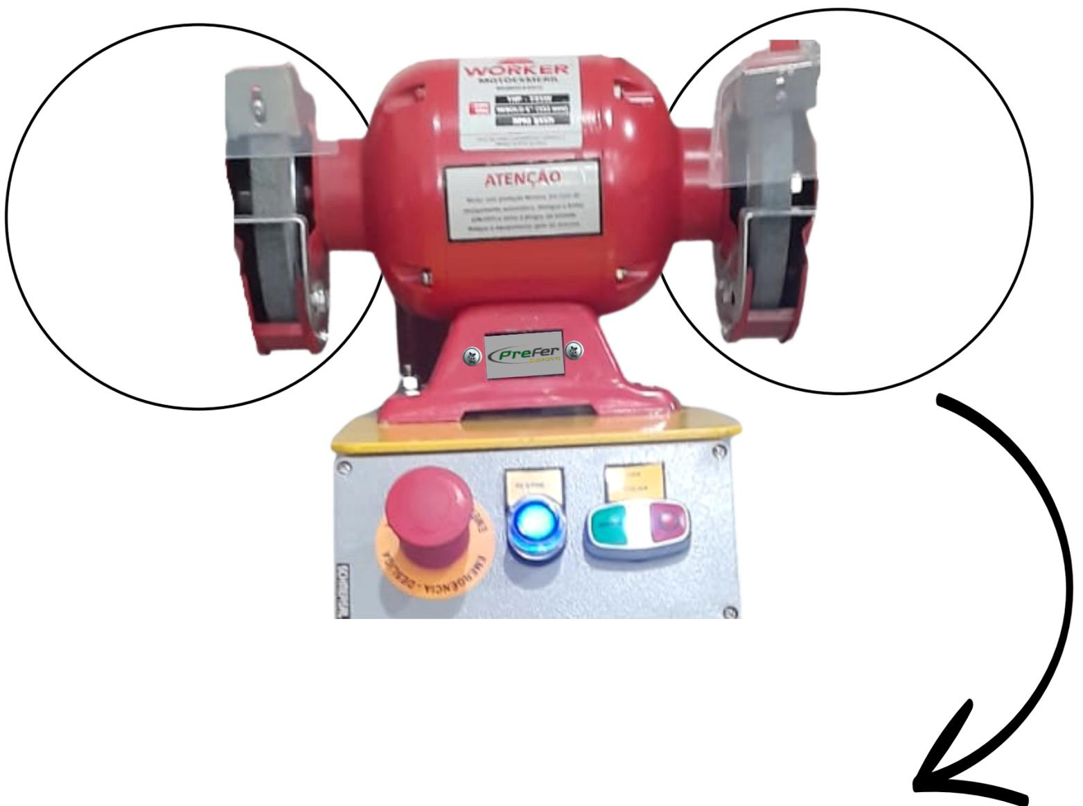
➤➤➤ **PROTEÇÕES MECÂNICAS COM REGULAGEM EM POLÍCARBONATO**
